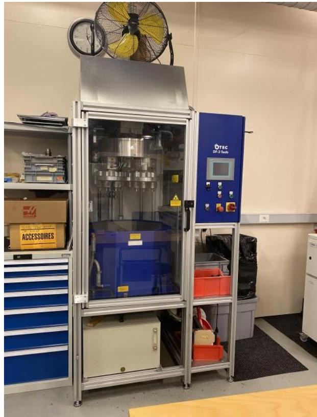
Máquina de acabado para el tratamiento de piezas, herramientas de corte y utillaje
