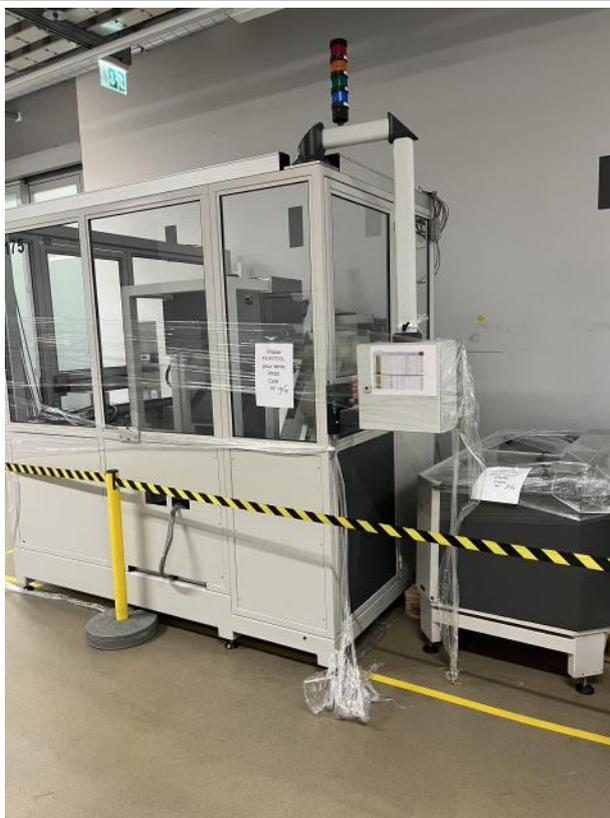
Prensa oscilante SCHMID para conformado por compresión en frío
