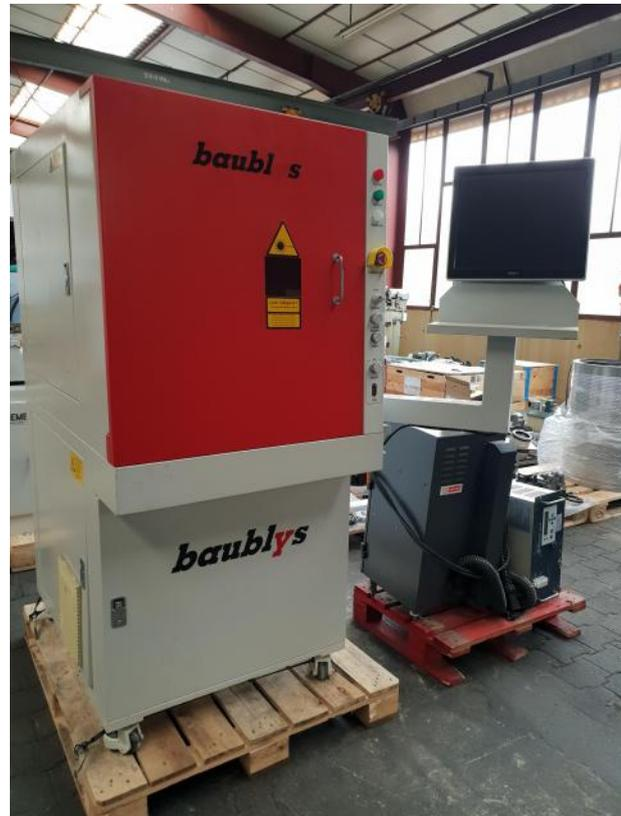
La máquina de grabado láser UV está diseñada principalmente para grabar fácilmente plástico y vidrio. También puede marcar otros materiales como metales y papel.
