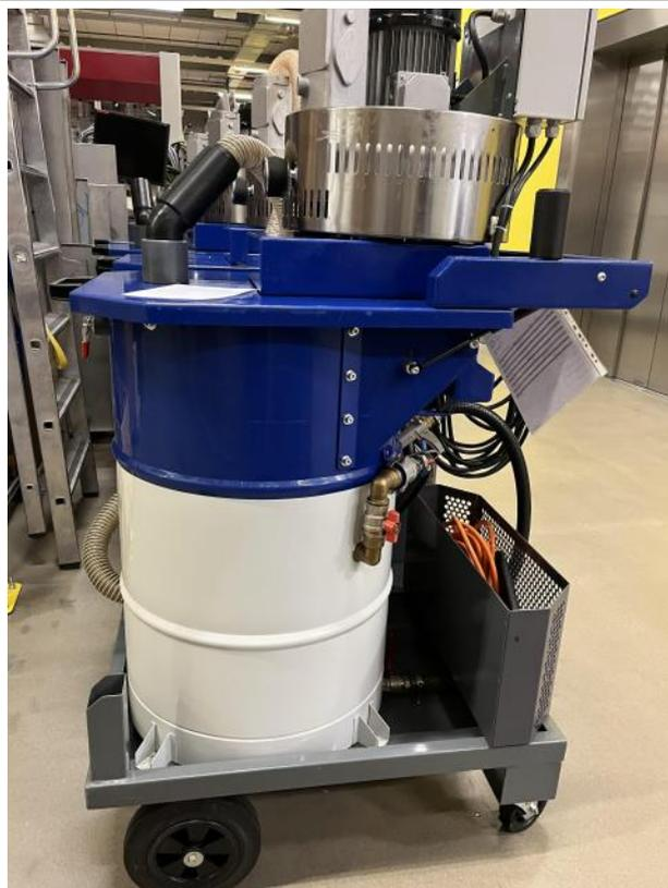
Aspirador industrial multiusos, diseñado para el vaciado de contenedores de máquinas herramienta y operaciones diarias de mantenimiento.
